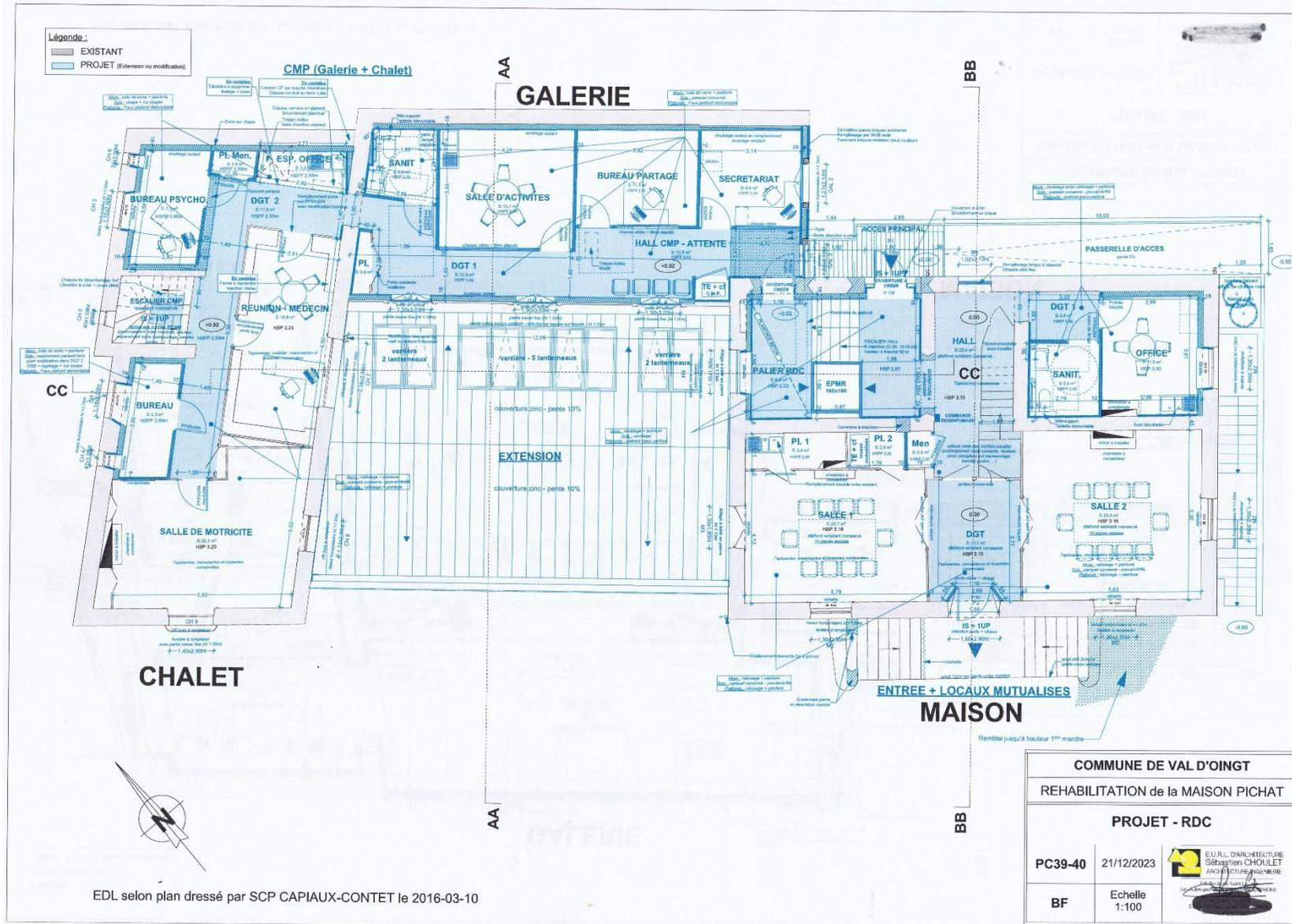
Plan du rez-de-chaussée et de la galerie avec vue sur le toit en zinc de la bibliothèque. Toutes les surfaces en bleu sont des espaces de circulation pris sur les surfaces utiles actuelles à 80%. Les bureaux de l'UDAF et du CMP disposent de surfaces et de lieux de rangements bien supérieurs à ceux de la bibliothèque qui n'a qu'un seul sanitaire commun à tous (public et personnels) et un bureau de 6m<sup>2</sup> pour le personnel. 11-05- 2024
